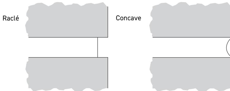
Joint de mortier recommandé 10 mm (1/2 po)
